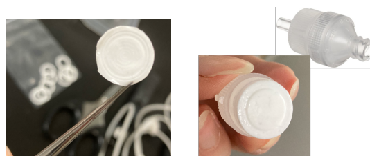
図6 トロンビン固定化不織布のフィルター化 (13 mmφ) (左) とフィルターホルダーへのセット (右)
