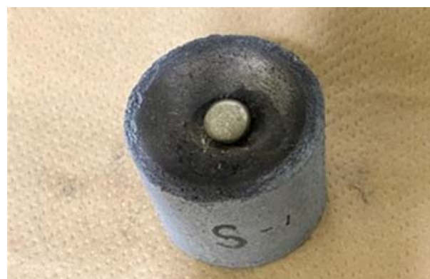
Fig.4 Thermal decomposed metallic titanium from the produced TiS_x by the coffee husk using an electron beam melting method / コーヒー殻を用いて作製した硫化チタン粉末を電子ビーム溶解法により熱分解することで得られた金属チタン塊
