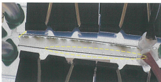
図7 連続分離のために長時間分離を行った流路。流路内にとどまった気泡(黄矢印は、分岐口に残り大きくなった気泡。破線円は、電極に残り成長した気泡。いずれもサンプルの流れを阻害する。)
