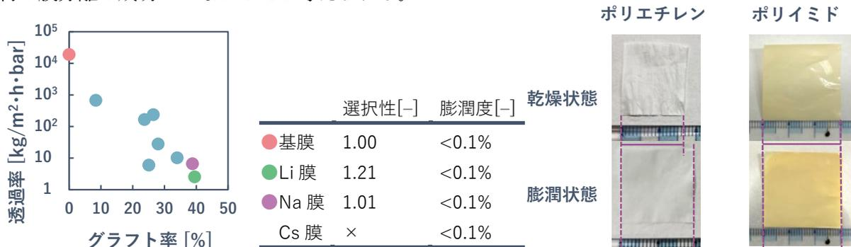
図6. (左)多孔質ポリイミド膜へのグラフト率と溶媒透過率の関係、(中)置換イオンと溶媒選択性・膨潤度の関係、(右)ポリエチレン・ポリイミドグラフト膜の溶媒に対する膨潤度の比較
